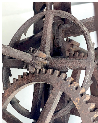
▲ Fig. 13 : Roues d'échappement avec chanfreins de l'horloge de Mehun française et l'horloge de Würzburg Bourgognienne. Les rayons de l'horloge de Mehun sont plus fins. Ils sont créés séparément et puis forgés dans l'anneau de la roue (visible par exemple au milieu du mouvement de Würzburg).
