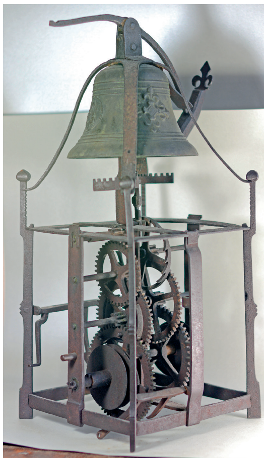
▲ Fig. 15 : À gauche: Manuscrit technique des années 1445 - 1484 montrant une horloge à ressort (fusée visible en bas) avec un foliot courbé comme un 'S' avec des petits poids de réglage (avec des palettes plates), British Library, Manuscrit 34113 À droite : foliot courbé comme un S de l'horloge de Mehun sur Yèvre présentée ici.
