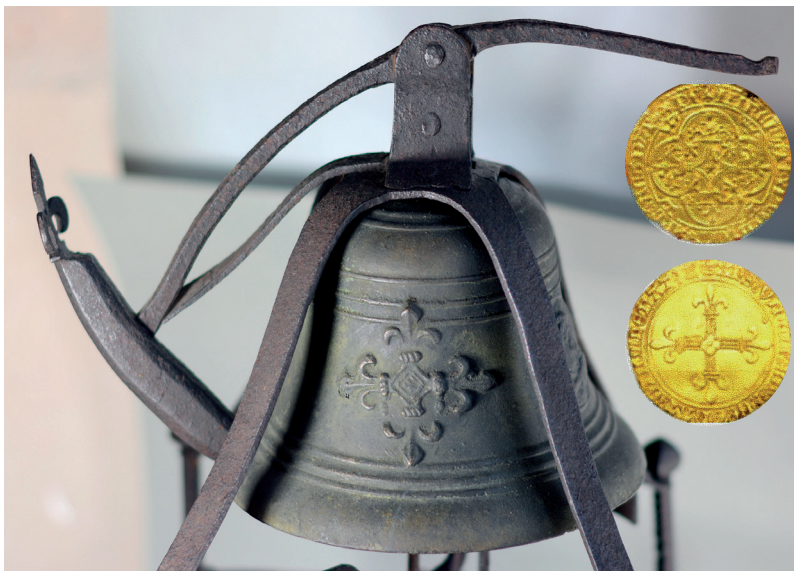
◀ Fig. 17 : La cloche et le marteau de l'horloge de Mehun sur Yèvre (système de marteau en dehors, fixé au bout du clocher comme était typique pour les horloges Françaises du 15 e siècle). Les fleur-de-lys en forme quadrilobe constituent une forme mixte entre ceux qu'on trouve sur les écus d'or de Charles VII (en haut) et Louis XI (en bas), soulignant une datation de l'horloge vers 1460.
