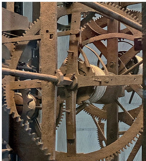
▲ Fig. 3 : Mouvement de l’horloge astronomique par Jean Fusoris dans la cathédrale de Bourges, vers 1424 (Serrurier André Cassart).
