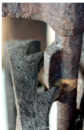
▲ Fig. 14 : À droite : dessin par Paulus Almanus montrant un balancier avec des palettes incurvées Stadt- und Staatsbibliothek Augsburg, Cod. 209, fol 36v. À gauche : Palettes incurvées (celle du haut avec la roue de rencontre à gauche) de l'horloge de Mehun présentée ici.
