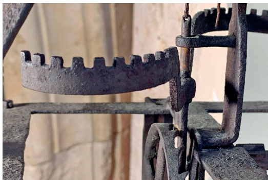
▲ Fig. 15 : À gauche: Manuscrit technique des années 1445 - 1484 montrant une horloge à ressort (fusée visible en bas) avec un foliot courbé comme un 'S' avec des petits poids de réglage (avec des palettes plates), British Library, Manuscrit 34113 À droite : foliot courbé comme un S de l'horloge de Mehun sur Yèvre présentée ici.
